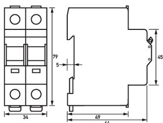
Dibujo acotado Interruptores-seccionadores RH 040-200
