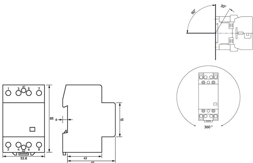
Dibujos acotados Contactores de instalación HS 3-024AC/63-40
