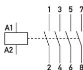
Ejemplo de cableado Contactores de instalación HS 3-024AC/63-40
