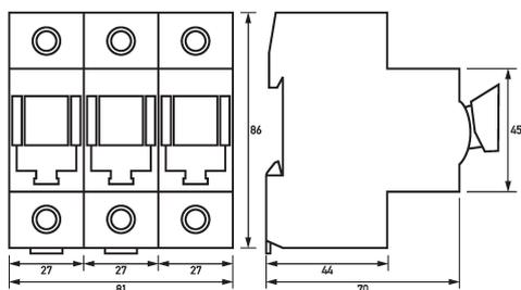
Dibujo acotado Interruptores-seccionadores con fusibles Tytan II Do-63-3/V
