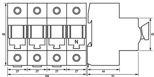
Maßzeichnung Sicherungslasttrennschalter Tytan II Do-63-3+N
