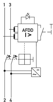
Ejemplo de cableado Dispositivo de protección contra errores en el arco eléctrico DAFDD 1 B25/0,03/2-A KV
