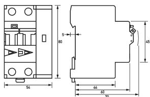
Dibujo acotado Dispositivo de protección contra errores en el arco eléctrico DAFDD 1 B25/0,03/2-A KV
