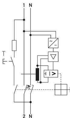
Ejemplo de cableado Combinaciones de interruptores diferenciales e interruptores magnetotérmicos DRCBO 4 C16/0,30/1N-PV
