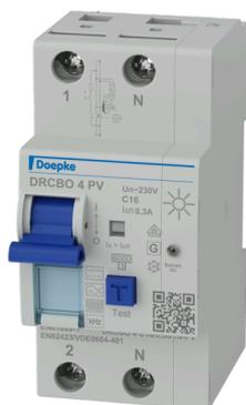
**Combinaciones de interruptores diferenciales e interruptores magnetotérmicos****DRCBO 4 C16/0,30/1N-PV****sensibles a todo tipo de corrientes, para sistemas FV, resistencia aumentada a la intensidad dinámica, breve tiempo de retardo, resistentes a la intemperie, Protección contra incendios hasta 20 kHz**
