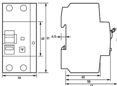
Dibujo acotado Combinaciones de interruptores diferenciales e interruptores magnetotérmicos DRCBO 4 C16/0,30/1N-PV
