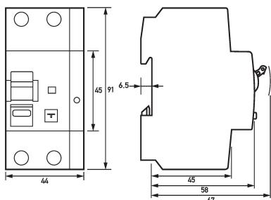
Dibujo acotado Combinaciones de interruptores diferenciales e interruptores magnetotérmicos DRCBO 4 C32/0,03/1N-B+
