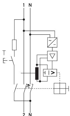
Ejemplo de cableado Combinaciones de interruptores diferenciales e interruptores magnetotérmicos DRCBO 4 C32/0,03/1N-B+
