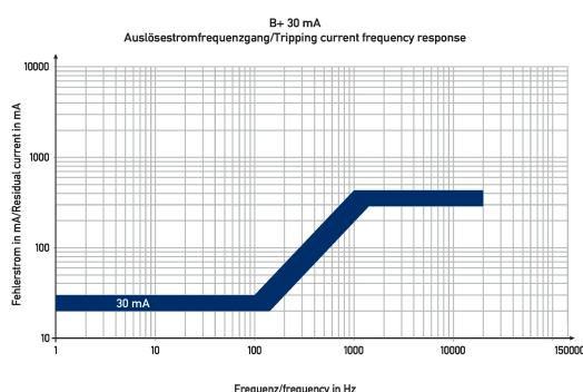
Diagramas Combinaciones de interruptores diferenciales e interruptores magnetotérmicos DRCBO 4 C32/0,03/1N-B+
