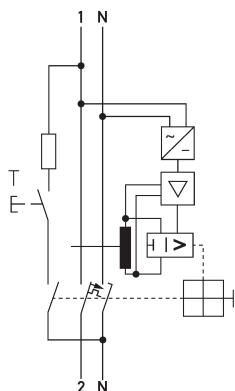
Ejemplo de cableado Combinaciones de interruptores diferenciales e interruptores magnetotérmicos DRCBO 4 C25/0,30/1N-B NK
