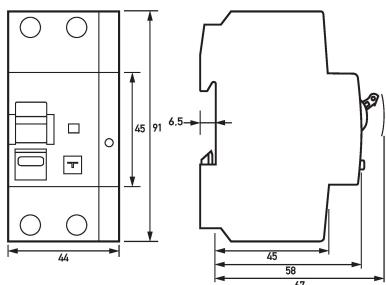
Dibujo acotado Combinaciones de interruptores diferenciales e interruptores magnetotérmicos DRCBO 4 C20/0,10/1N-B SK
