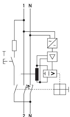
Ejemplo de cableado Combinaciones de interruptores diferenciales e interruptores magnetotérmicos DRCBO 4 C20/0,10/1N-B SK
