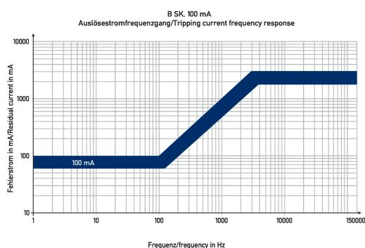
Diagramas Combinaciones de interruptores diferenciales e interruptores magnetotérmicos DRCBO 4 C20/0,10/1N-B SK
