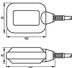
Dibujo acotado Interruptores de flotador Champ 2 GS-L/F 10 m
