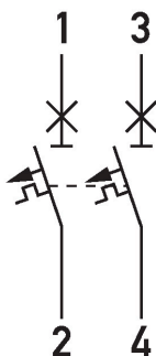
Anschlusschema DLS 6i, B-Charakteristik, zweipolig, 10kA
