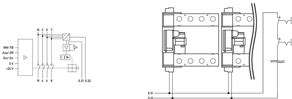
Ejemplo de cableado Interruptores-seccionadores DHS 4-063 FANA24DC
