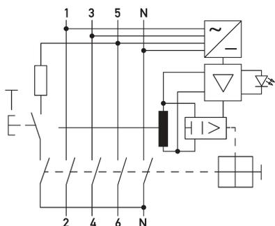
Ejemplo de cableado Interruptores diferenciales DFS 4 063-4/0,30-HP R
