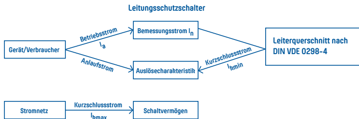
Abb. 9: Ablaufschema - Dimensionierung und Planung
